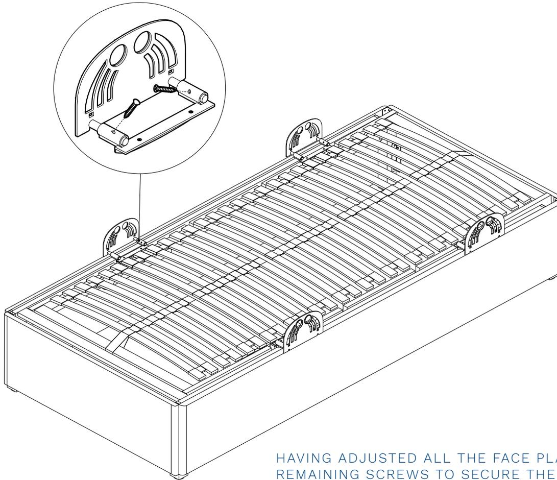
HAVING ADJUSTED ALL THE FACE PLATES, USE THE REMAINING SCREWS TO SECURE THE FACE PLATES.
