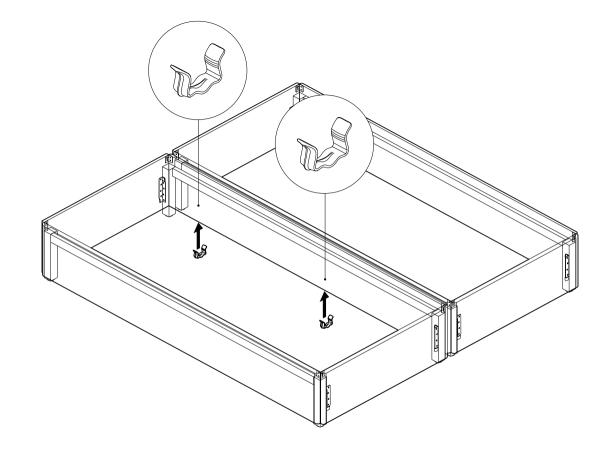
SECURE THE 2 JOINING CLIPS TO THE BOTTOM EDGE OF THE INSIDE PANELS. NOTE: IF YOU HAVE DRAWERS, POSITION THE CLIPS AFTER FITTING THE DRAWERS.
